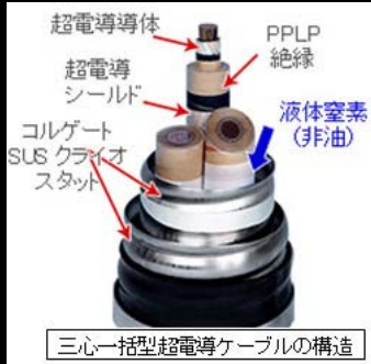
三心一括型超伝導ケーブルの構造
